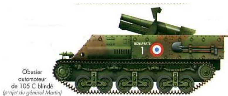
Projet d'automoteur de 105 sur chassis Lorraine 39 L (non réalisé)
